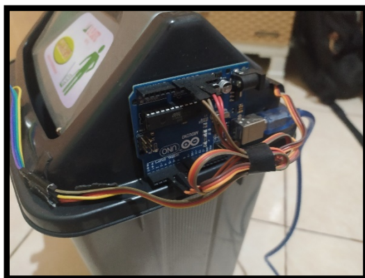
Gambar 3. Pemasangan Arduino dan Kabel
