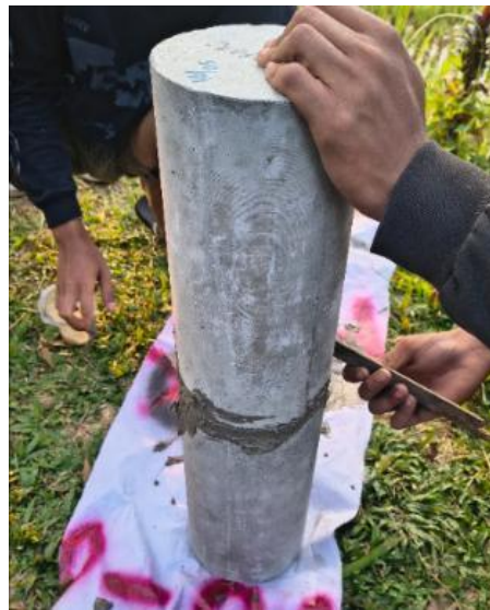
Gambar 2. Proses perekatan beton silinder menggunakan lem beton
